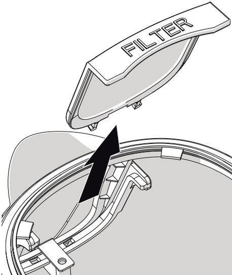
2. Den Filter unter laufendem Wasser und mit einer weichen Bürste reinigen.
