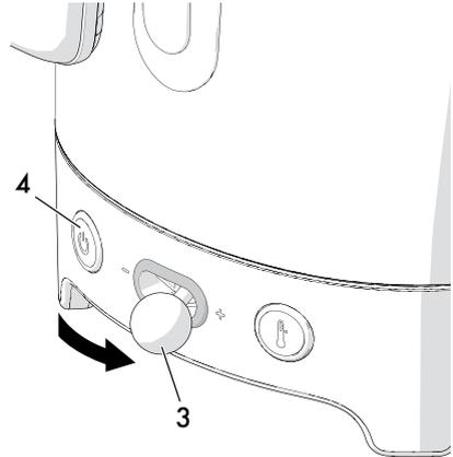
8. Die START-/STOPP-Taste (4) drücken: ein Signal und das Aufleuchten der LED-Lampe zeigen den Start des Zyklus an. Die LED-Lampe der ausgewählten Temperatur schaltet sich ein, während die der Temperaturen, die unter der eingestellten liegen, blinken. Diese schalten sich bei Erhöhung der Wassertemperatur nach und nach ein.
